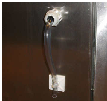
Figur 5. Montering av tryckslang för mätning av atmosfärstrycket.
