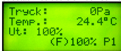
Figur 6. FKP-R/R2 informations-skärm i tryckreglerat läge med utetemperaturkompensering och aktivt veckoschema där program P1 körs med 100% av tryckbörvärdet. F:et visar att driften går i forcerat läge.
