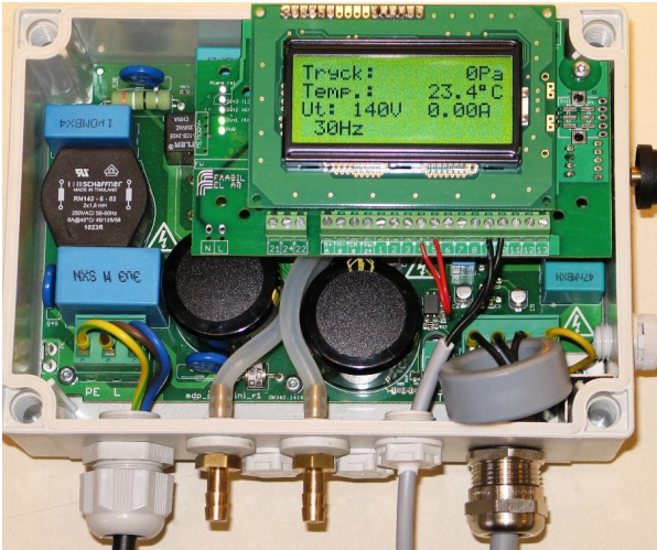
Figur 3. Elektrisk och mekanisk inkoppling av FKP-M i normal applikation med ferritring på utgående motorfasar. Byglad för rotationsriktning. Se Inkoppling för beskrivning av inkoppling av motorkabel.
